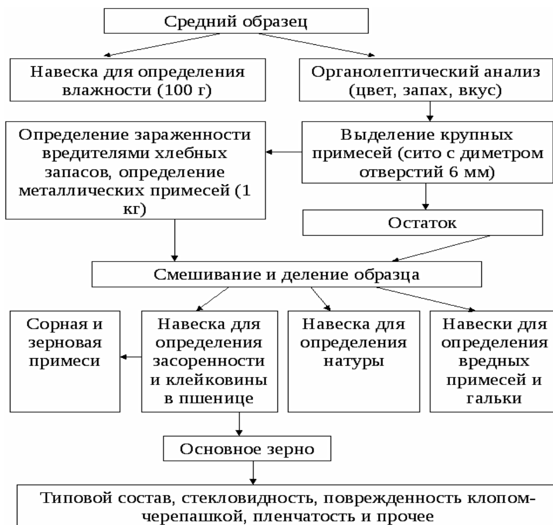
Рисунок Б 1 – Порядок проведения анализа зерна
