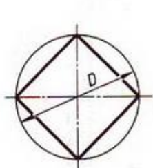
Разделить окружность на 4 и 8 равных частей
