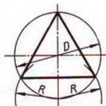
Разделить окружность на 3 и 6 равных частей
