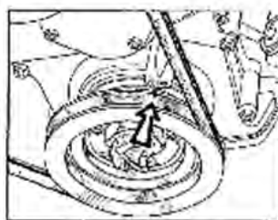
Рис. 6. Расположение метки ВМТ на двигателе:
