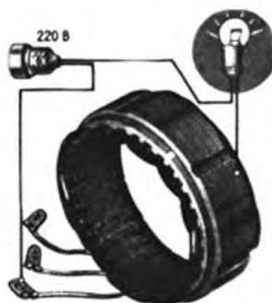
Рис. 10. Проверка обмотки статора и обрыв Рис. 11. Проверка обмотки статора на замы- кание с корпусом
