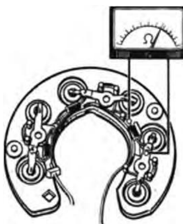
Рис. 19. Проверка дополнительных диодов выпрямительного блока БПВ генератора 37.3701
