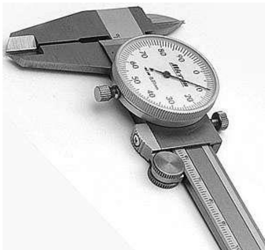
Рис.4 Штангенциркуль со стрелкой на круговой шкале
