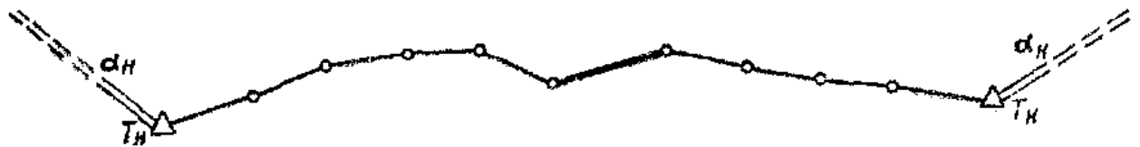
Рис. 1. Полигонометрический ход с промежуточным дирекционным углом
